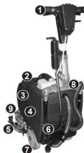
**1°** La poignée ergonomique réglable offre un meilleur contrôle tout en réduisant la fatigue de l'opérateur.
