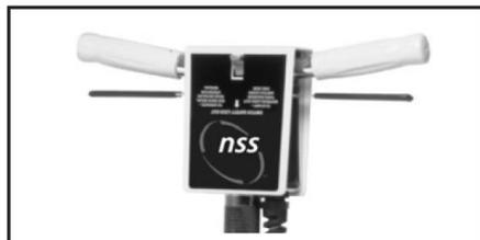
Lorsque la machine est à l'arrêt, le dispositif de blocage évite tout démarrage accidentel.
