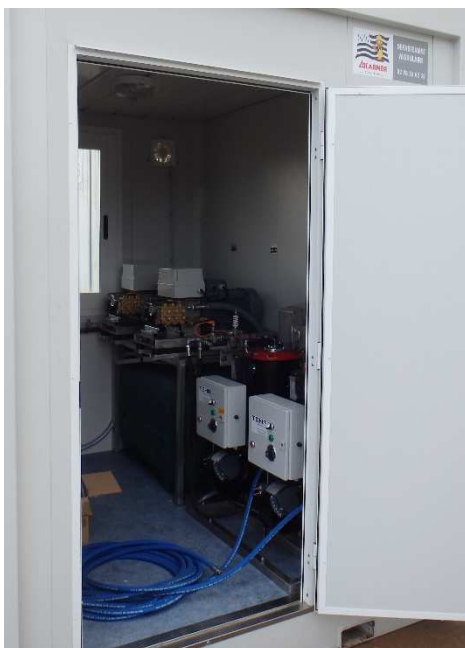
Nettoyeurs HP adaptés dans une construction modulaire
