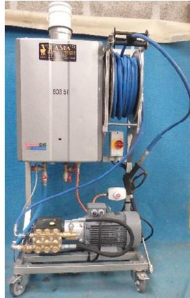
Exemple de nettoyeur HP eau chaude en salle de traite
